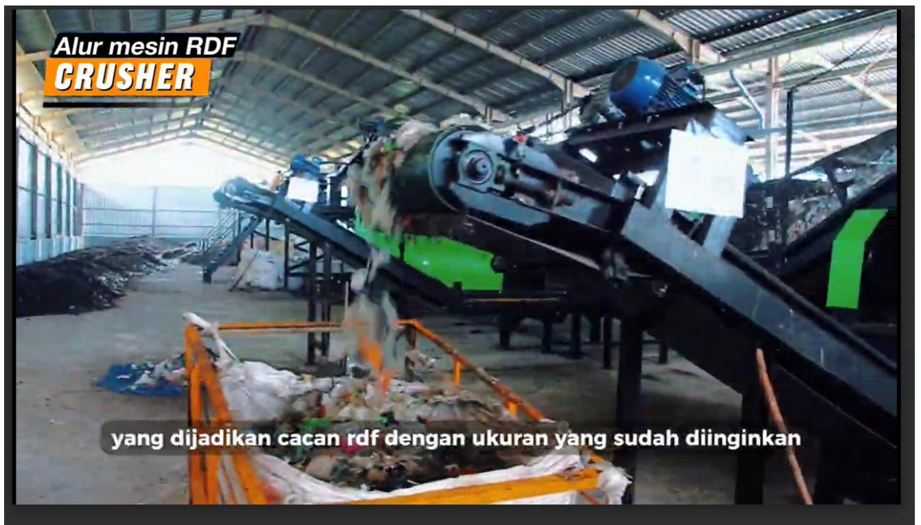
Gambar 3. 3 Metode RDF Untuk Pengolahan Sampah
